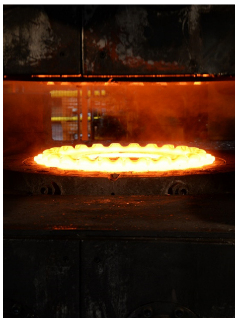
Schmieden eines Kettenrads für Minenbagger
